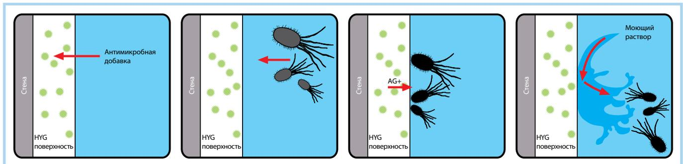
Ионы серебра были включены в объем смеси ПВХ до процесса экструзии, и улучшили уже существующую антимикробную активность жестких листов ПВХ. В настоящее время при непосредственном контакте, лист убивает широкий спектр микроорганизмов, в том числе и устойчивые к антибиотикам.
